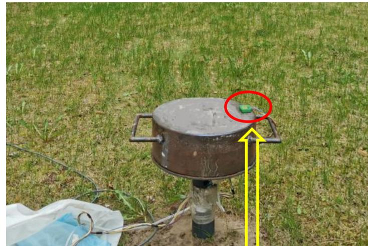
3 осевой цифровой акселерометр ADXL355 (в герметичном корпусе) :
