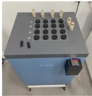
Ампулы заполняются сухой смесью в заданный пропорциях, затворяются водой, плотно закрываются и помещаются в калориметр для проведения исследований при трех различных температурах. Рассматриваются первые 10 ч протекания реакции.
