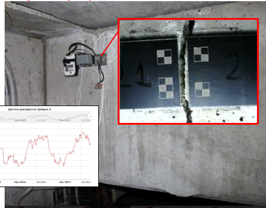
Рис. 10 Датчики трещиномеры, расположенные в блоке «D» для контроля величины раскрытия трещин в ж/б балках.
