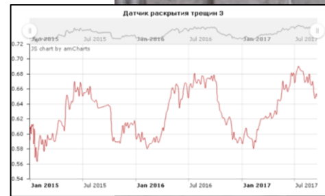
Рис. 10 Датчики трещиномеры, расположенные в блоке «D» для контроля величины раскрытия трещин в ж/б балках.
